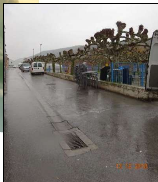
Ilustración 44. Alcantarillado , en la margen izquierda aguas abajo del puente, a través del que se inicia la inundación en esta área. Como señalaron los técnicos municipales durante la visita de campo, este es uno de los puntos de mayor importancia en el momento de iniciarse la inundación en el casco urbano de Funes. Antes de iniciarse los desbordamientos del cauce, se inicia el retorno de pluviales a través de las alcantarillas mostradas en las imágenes, y que con rapidez pueden provocar la inundación de esta zona urbana, incluyendo el parque infantil.
