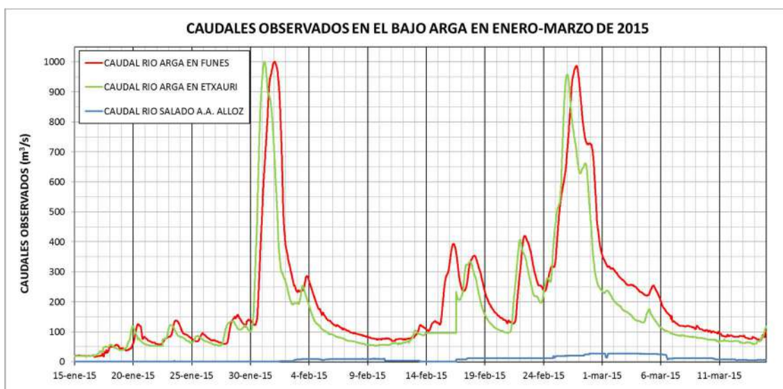
Ilustración 36. Caudales observados en las estaciones de aforo de Etxauri, Funes y el río Salado A.A. de Alloz, durante dos eventos de gran magnitud que ocurrieron en el periodo de enero-marzo de 2015 en la cuenca del Arga. Se trata en concreto de los eventos 9 y 10 mostrados en la Tabla 7 .
