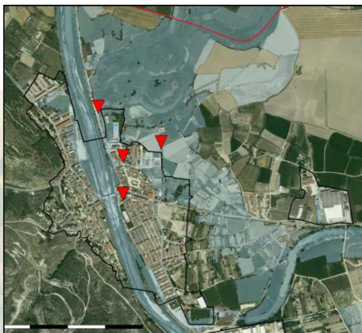
Ilustración 41. Localización de las acequias y alcantarillado de mayor importancia para el inicio o propagación de la inundación en el casco urbano. Mancha de T=10 años sobre ortofoto.
