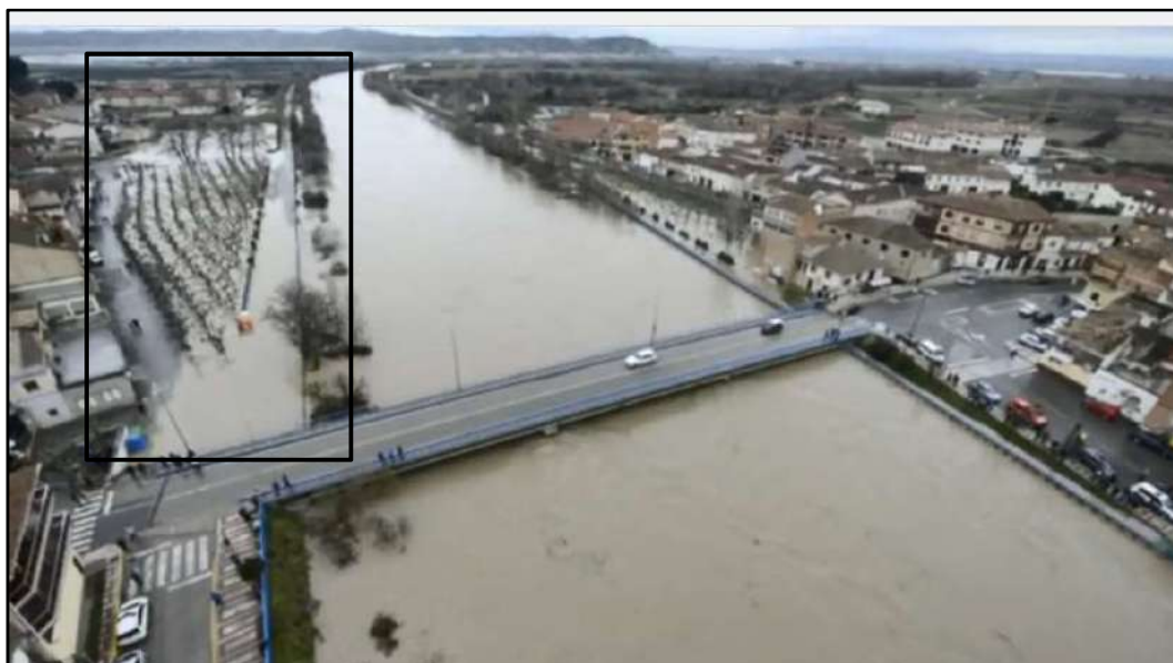
Ilustración 31. Imágenes de desbordamientos anteriores en la margen derecha del Arga en el casco urbano de Funes. En este caso las inundaciones se inician por desbordamientos en la zona del Paseo de La Mejana , aguas arriba del puente. Esta zona se ha señalado mediante recuadros en ambas fotografías.
